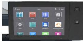
**Une écran tactile de type tablette personnalisable** vous permet d'en faire encore plus en moins de touches et d'étapes. L'imprimante multifonction C625 est dotée d'une interface utilisateur (IU) réglable ou inclinable de 7 pouces. Une interface utilisateur de 5 po est installée sur la C620. Les deux fournissent un accès facile à la Bibliothèque des applis de Xerox.
